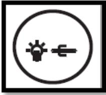
Este mando permite la función Grill / Rotisserie se active o la luz interior del horno se enciende para comprobar el progreso de la cocción de la comida.
